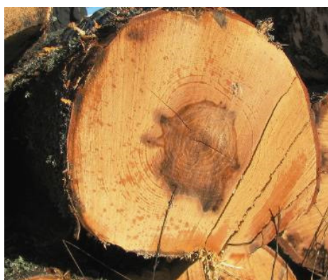
Joonis 21. Järkamislõhed noti otspinnal. Joonis 22. Harvesterirullikute kahjustus
