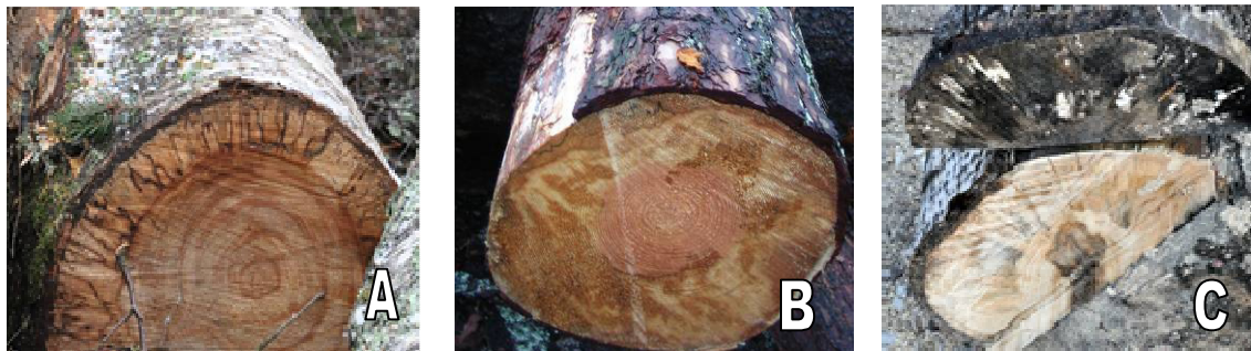
Joonis 15. Laomädaniku näiteid. A- kasenoti ristlõikel; B- männi maltspuidus; C- haavanotil.
