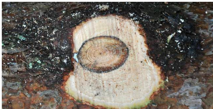
Joonis 2. Kuiva oksa eristab ümbritsevast puidust tumedam piirjoon.
