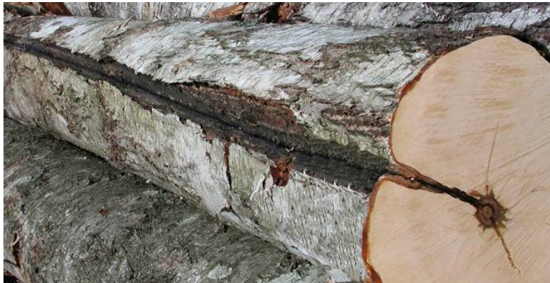
Joonis 12. Külmalõhe kase noti kül- ja otspinnal.
